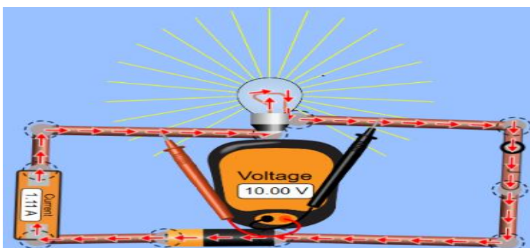
Figura 3 Circuito que mostra o movimento dos electrões movendo em sentido convencional. Fonte Autor
