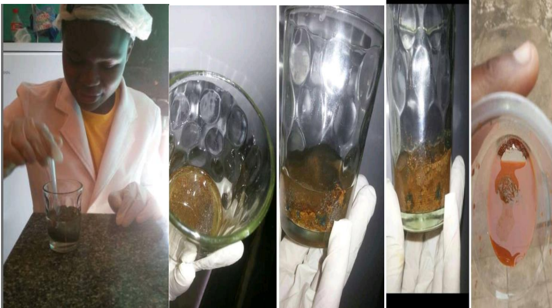
Figura 13. a) Palha-de-aço mergulhada na solução de hipoclorito de sódio. b) Processo da reacção após 10 e 50 minutos. c) Processo da reacção após 8 horas.
