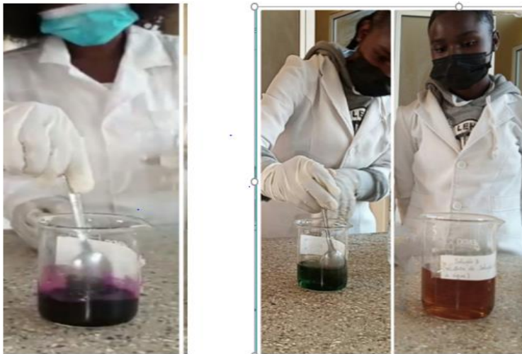
Figura 10. Mistura das soluções 1 e 2, formação de iões manganato ( \text{MnO}_4^- ) com coloração verde intenso; formação do dióxido de manganês ( \text{MnO}_2 ), com coloração marrom.
