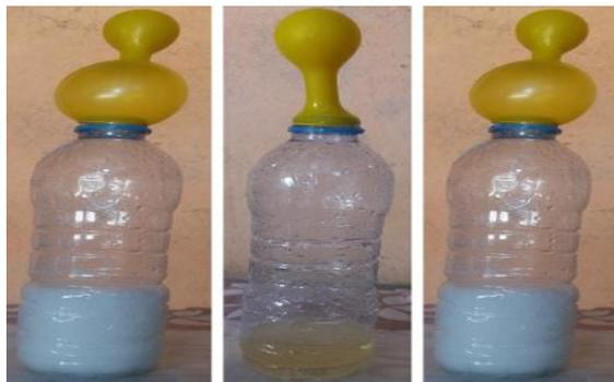
Figura 14. Demonstração do comportamento dos gases em relação o volume e pressão.
